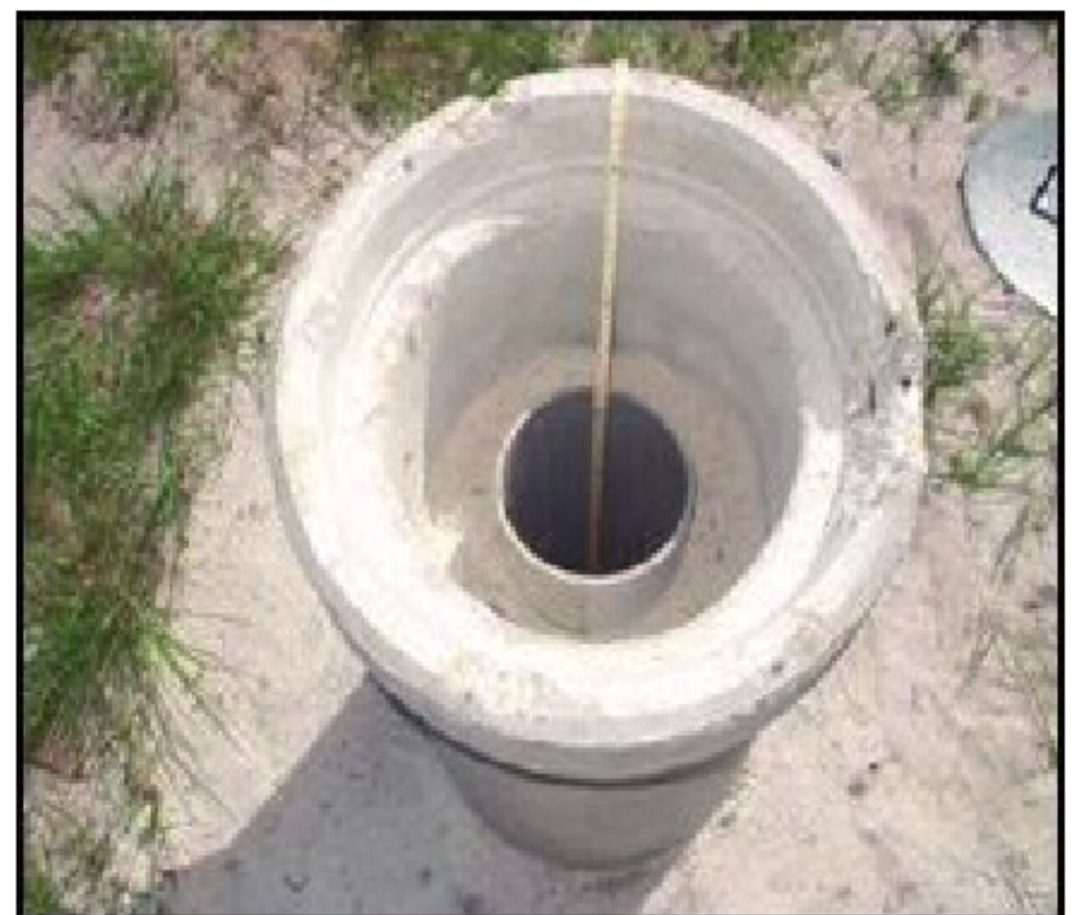
Exemple de piézomètre où la mesure du niveau piézométrique est faite à l'aide d'une sonde manuelle (Portail National ADES)
